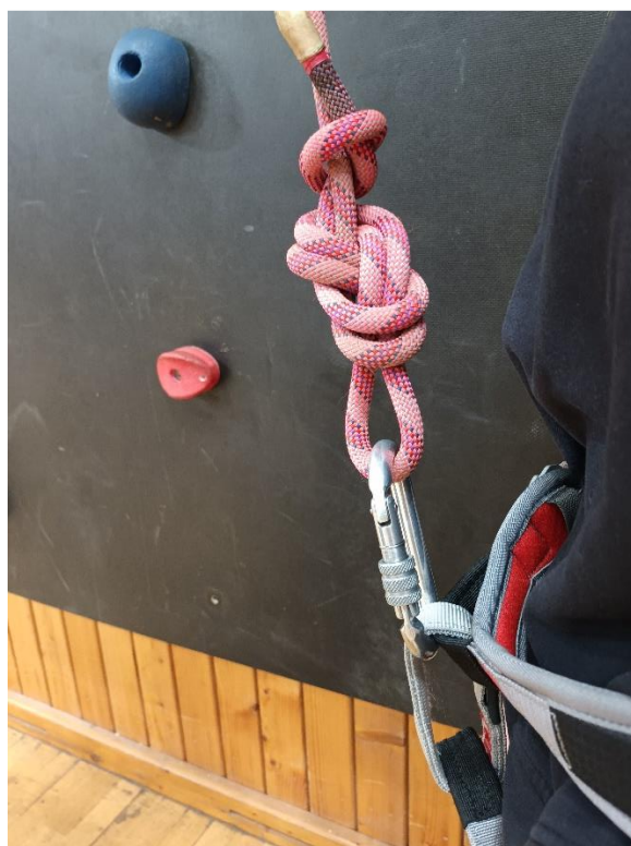
Foto br. 4 – pravilno postavljen karabiner sa smjerom zavrtnja bravice prema dolje.
