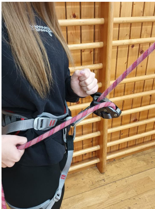
Foto br. 5 – pravilno korištenje Grigri spravice za osiguravanje
